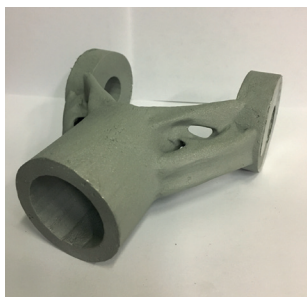
Obr. 16. Prototypový odlitek závěsu po odstranění vtokové soustavy
