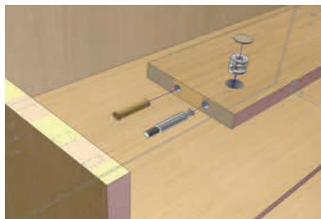
Woodwork pro Inventor používá vlastní metody umisťování komponent, které využívají vazby (iMate) připravené v prostředí sestavy. Návrhář tedy pouze jednoduše specifikuje, který ze spojovaných dílů je nosný a který má být s tímto nosným dílem spojený. Na základě této definice bude kování automaticky umístěno do všech potřebných pozic. V porovnání se standardním mechanismem v Autodesk Inventoru nabízí tato metoda mnohem rychlejší přípravu spojů na celém nábytku.
