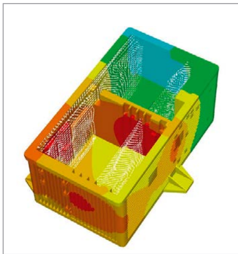
Modely tepelného toku uvnitř digitálního systému řízení palby. Snímek poskytla společnost Sechan.
